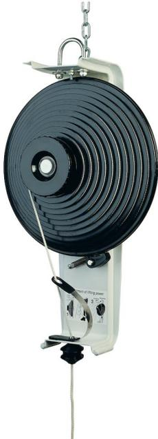
L'équilibreur supporte l'outil ou le tuyau et le maintient surélevé en permanence. Un frein centrifuge intégré empêche l'équilibreur de s'enrouler trop rapidement, ce qui minimise les risques de blessures corporelles et des dégâts matériels. Hauteur de levage, 8 m.
